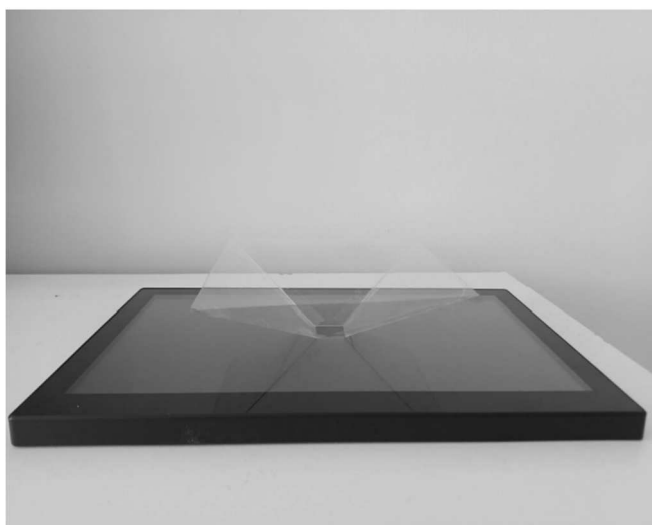
Rys. 4. Umieszczenie bryły do wyświetlania obrazów przestrzennych na ekranie
