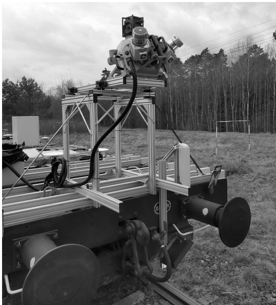
Rys. 3. Widok systemu MLS oraz fotogrametrycznego zainstalowanych na kolejowej platformie pomiarowej
