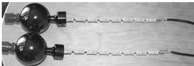
Rys.4. Łańcuchy rezystorowe wysokonapięciowych dzielników napięcia zastosowanych w kilowoltmierzu
