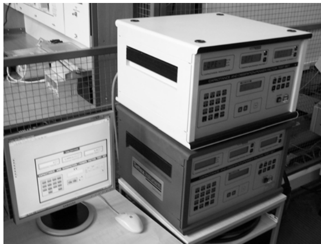
Rys. 3. Wysokonapięciowe mierniki pojemności i współczynnika strat dielektrycznych Tettex 2816 (u góry) i 2818 (na dole) oraz ekran komputera z widocznym graficznym interfejsem użytkownika projektowanego systemu pomiarowego
