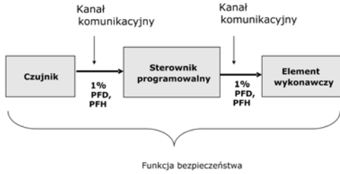
Rys. 2. Wymagania dotyczące niezawodności kanału komunikacyjnego
