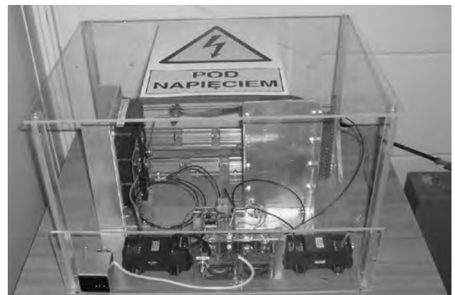
Rys. 1. Przykładowy, energoelektroniczny modulator napięć typu PWM , dla którego zaprojektowano opisany w artykule 2-kanałowy kilowoltomierz napięcia stałego
